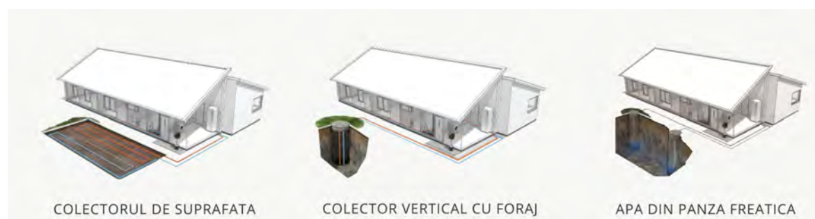
Figura 65: Pompe de căldură- amplasarea instalației exterioare
